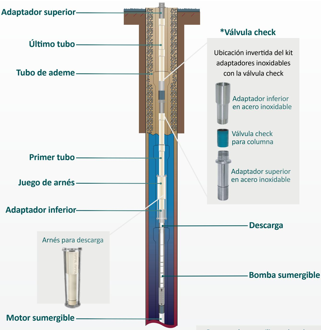
\*Para minimizar los efectos por golpe de ariete, se recomienda instalar válvulas check para columna cada 60 metros de carga, por lo tanto, se requerirá un kit de adaptadores inoxidables adicional para cada una de las válvulas check que requiera la instalación.
